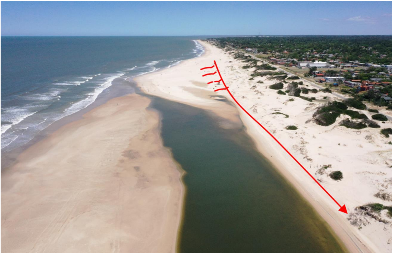
Figura 2: Se ejemplifican los sitios donde priorizar la colocación de cercas captoras de arena con la estrategia potenciar el ancho de playa desde donde el mismo se encuentra estabilizado, de Oeste a Este. Se observa un esquema general de la colocación sugerida. Con la flecha se señala la dirección con la cual se sugiere ir avanzando a medida que las cercas captoras se colmatan de arena.
