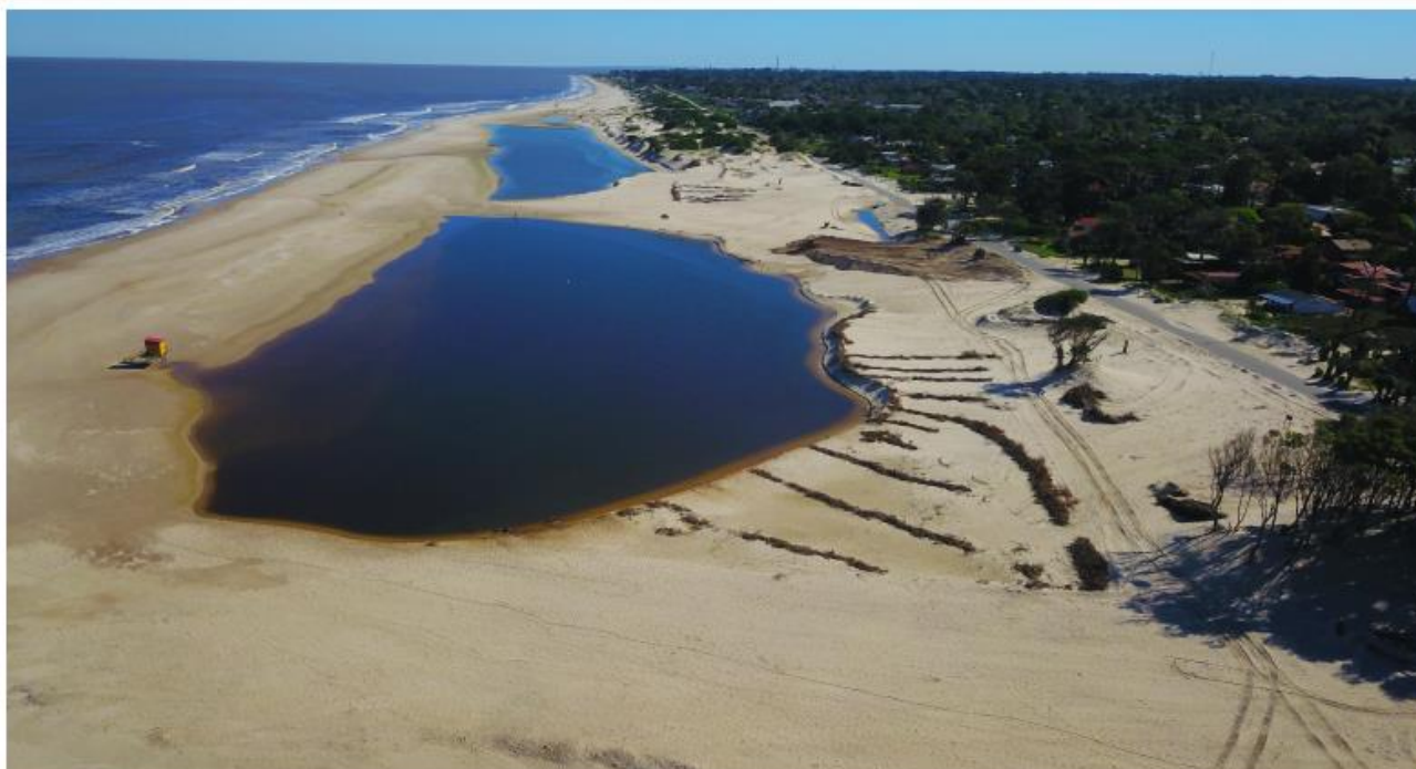
Figura 4. Imagen de dron de fecha 12 de abril (15 horas). Las cercas observadas en la imagen son un ejemplo de las ubicaciones desaconsejadas dada la dificultad de acumulación de arena en las mismas.
